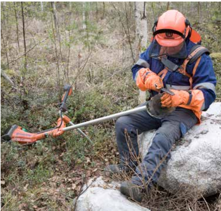
Kuva 23. Raivaussahan terää teroitettaessa on käytettävä suojakäsineitä.
