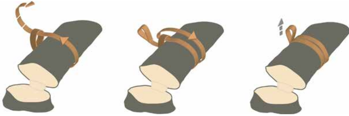
Kuva 46. Konkeliinan kiertäminen rungon ympäri. Puukanki pujotetaan liinan silmukkaan.
