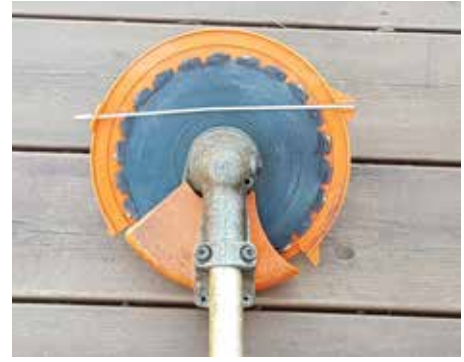
Kuva 19. Raivaussahan sektorisuoja on oltava ehjä ja paikallaan.
