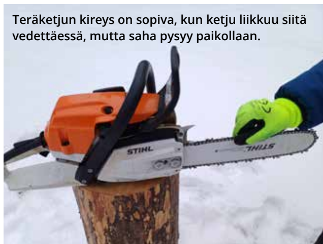
Kuvat 38–41. Moottorisahassa on monia työturvallisuutta parantavia ratkaisuja, joiden toiminta kannattaa säännöllisesti tarkistaa. Lisäksi ennen sahan käynnistämistä on hyvä varmistaa, että polttoaine- ja teräketjuöljysäiliöiden korkit ovat ehjät ja suljettu kunnolla.
