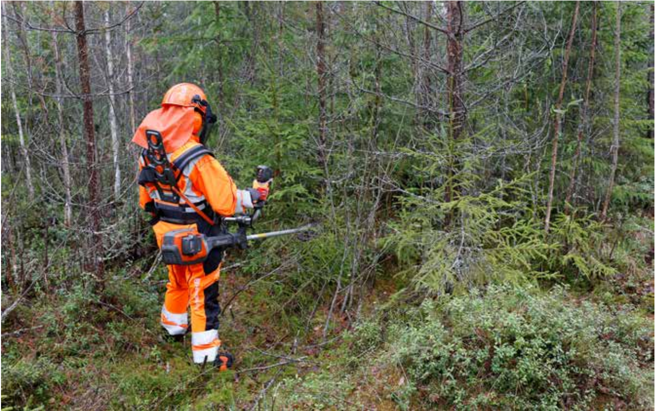
Kuva 18. Raivaussahalla työskentelyyn kannattaa aina hankkia tarkoituksenmukaiset varusteet. Valjaat on säädettävä sahaajalle sopiviksi.
