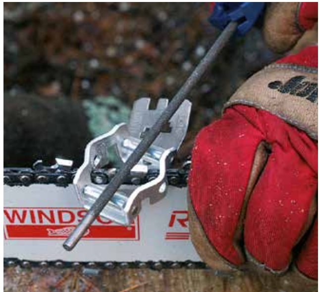
Kuva 37. Moottorisahan teräketjun kouruhampaan teroittamisessa ja säätö- eli puruhampaan alentamisessa kannattaa käyttää apuvälineitä. Viilat ja viilanohjaimet on helpointa hankkia moottorisahan tai teräketjun oston yhteydessä.
