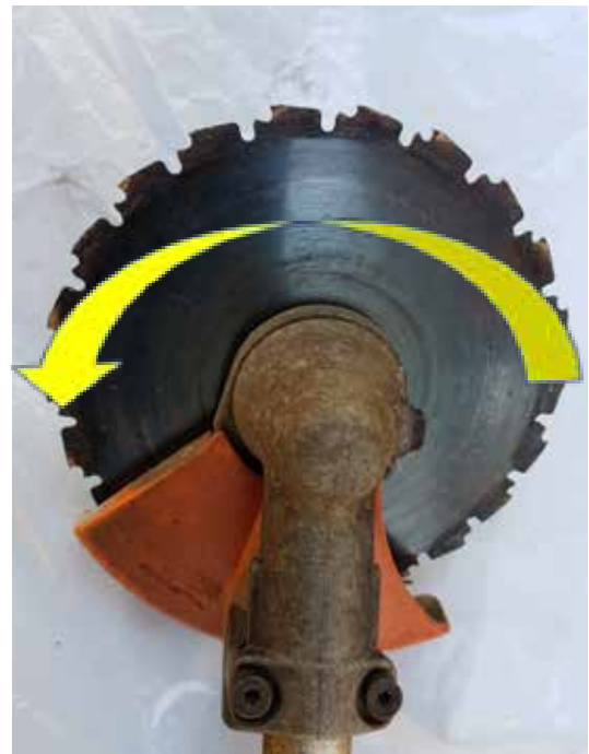
Kuva 24. Raivaussahan terä on kiinnitettävä paikoilleen oikein pyörimissuunnan mukaan.
