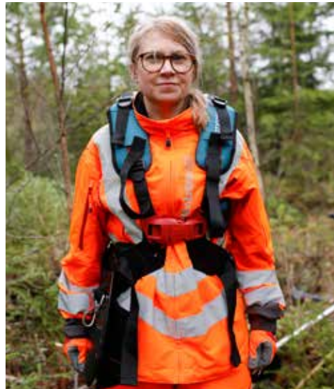
Kuva 21. Raivaussahan valjaat säädetään sahaajalle sopiviksi. Lisäksi täytyy selvittää, miten valjaiden lukitus toimii. Yllättävissä tilanteissa valjaat on pystyttävä avaamaan nopeasti.
