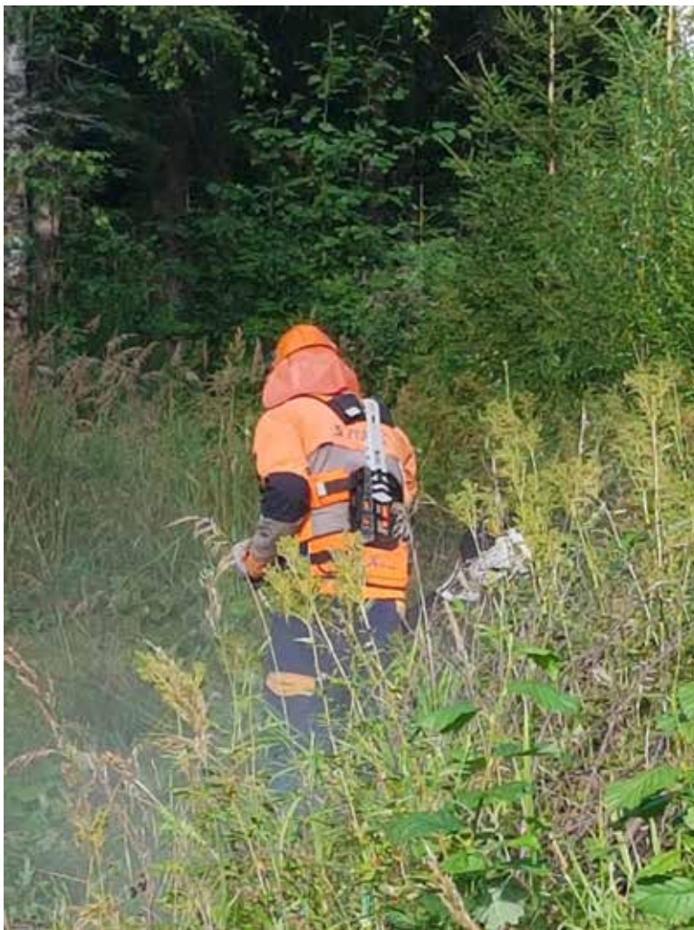
Kuva 12. Vesakkoterällä varustettu raivaussaha sopii metsänuudistamisalojen heinäntorjuntaan, varsinkin kohteilla, joissa haittaava kasvusto on vahvaa, esimerkiksi vadelmaa.
