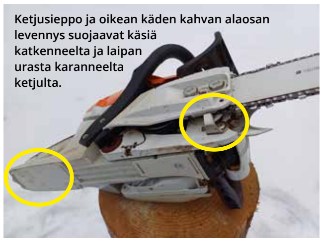
Kuvat 38–41. Moottorisahassa on monia työturvallisuutta parantavia ratkaisuja, joiden toiminta kannattaa säännöllisesti tarkistaa. Lisäksi ennen sahan käynnistämistä on hyvä varmistaa, että polttoaine- ja teräketjuöljysäiliöiden korkit ovat ehjät ja suljettu kunnolla.
