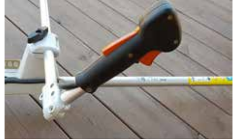
Kuva 20. Kaasukahvassa olevan turvaliipaisimen tarkoitus on estää raivaussahan tahaton kaasutus.
