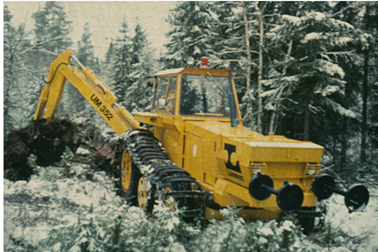
Kuva 6. Metsäojituskaivuri, jossa kevyet suotelat, hydraulinen voimansiirto ja muutokauha. Valok. Juhani Päivänen.
