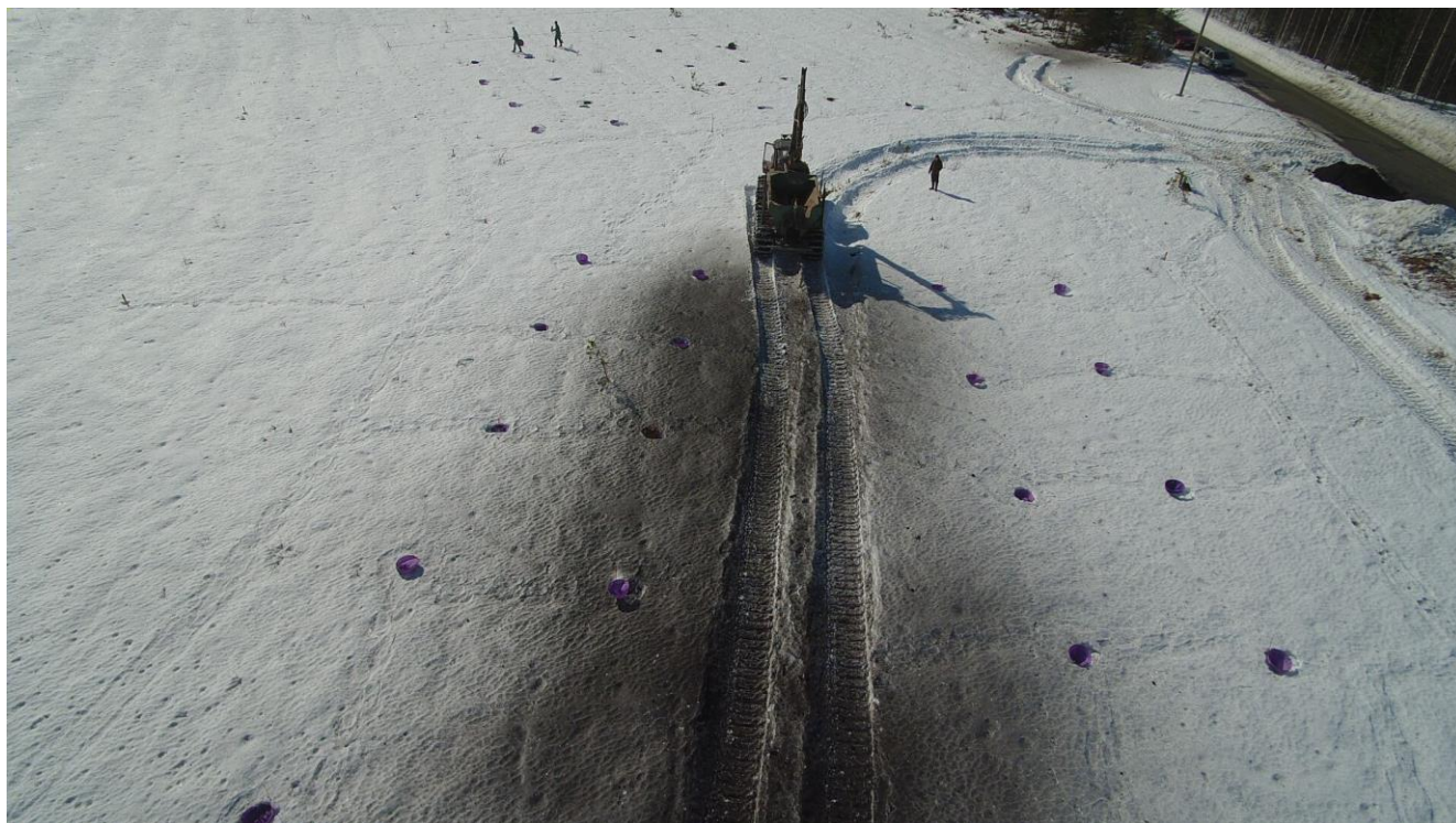
Kuva 17 Tuhkan levitystä UPM-Kymmene Oyj:n maalla 11.4.2018. Lumella näkyvät levitystasaisuuden tarkkailuun käytetyt suppilot Kuva: Antti Nevalainen.
