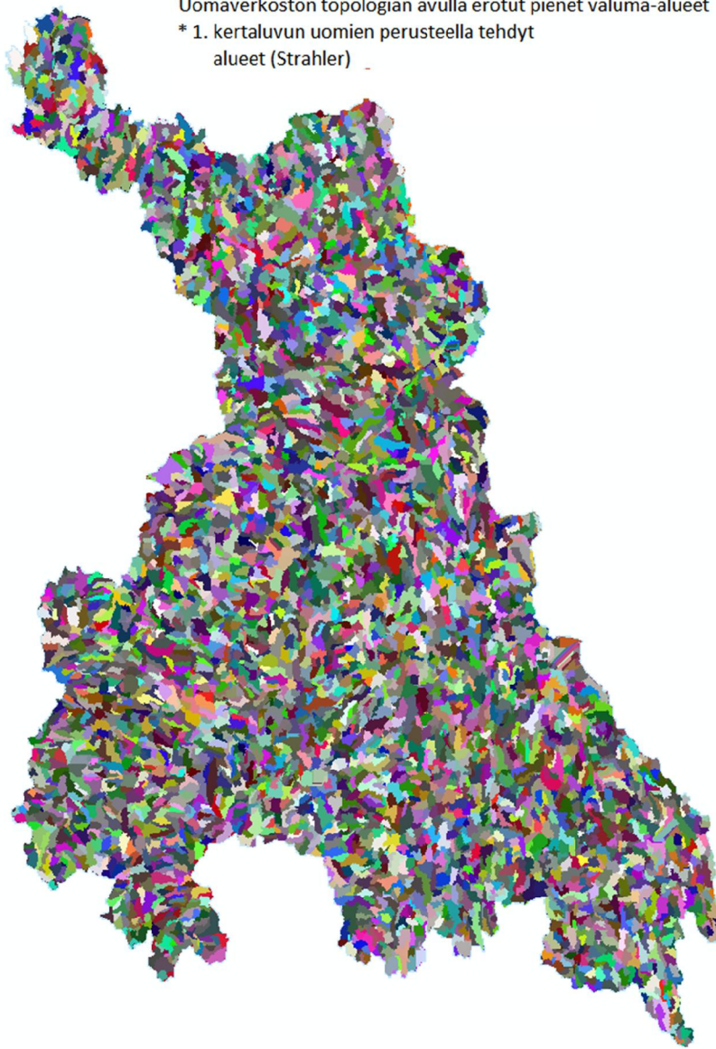
Kuva 2-3. Watershed -rasteri Kyrönjoen vesistöalueella. Strahlerin topologian mukaiset pienet valuma-alueet, joita on yhteensä 5757. Samasta datasta on muodostettu streamorder ja streamlink -rasterit. Nämä kolme rasteri muodostavat yhdessä hydrologisissa sovelluksissa tarvittavan topologia-datan.
