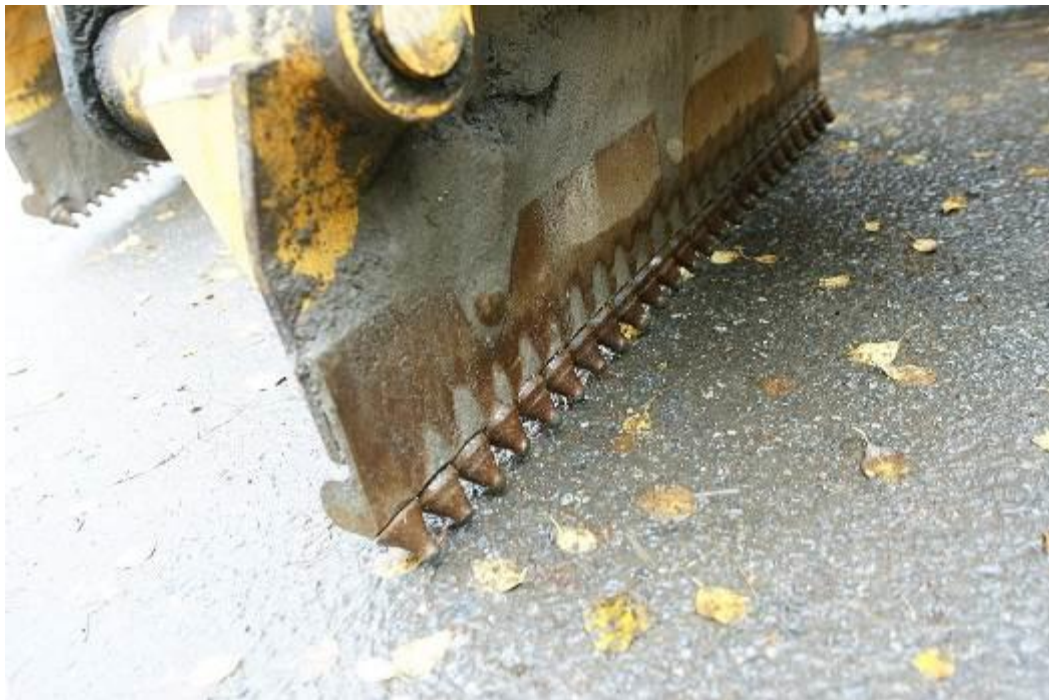
Kuva 28. Tappiterä soveltuu parhaiten kulutuskerroksen leikkaukseen.
