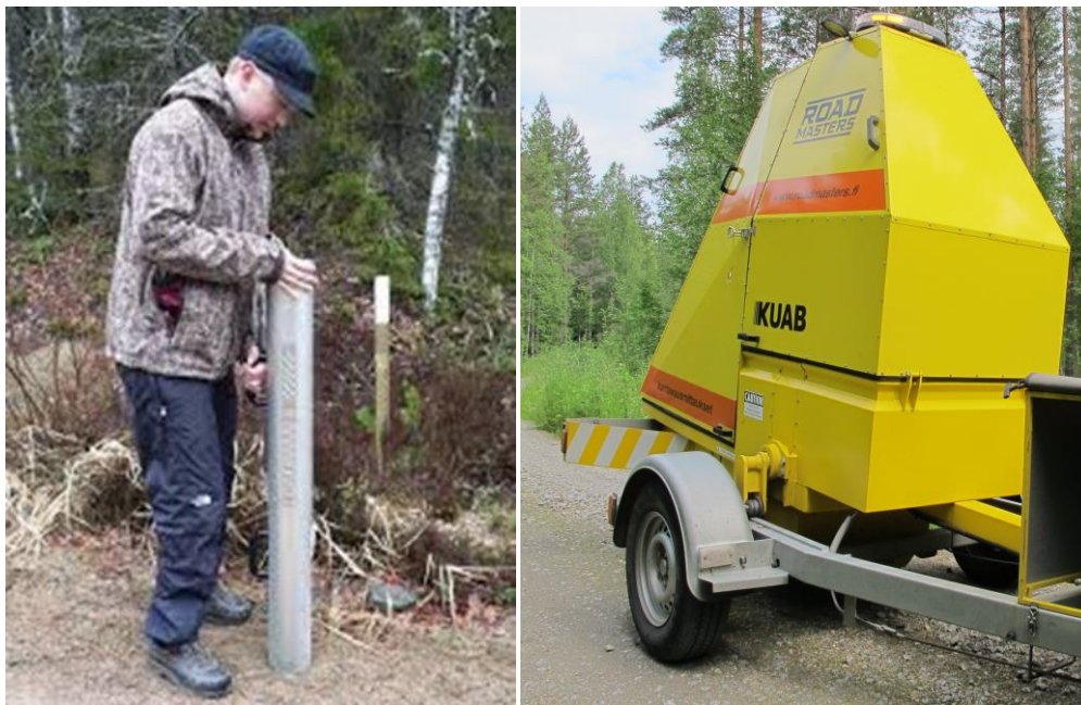
Kuva 40. Kannettava Loadman- ja Auton perässä vedettävä KUAB-pudotuspainolaite.
