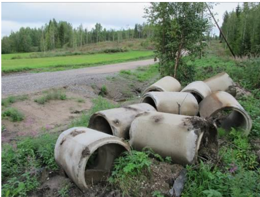
Kuva 43. Rikkoutuneen rummun ehjät renkaat voidaan käyttää toisella työmaalla.
