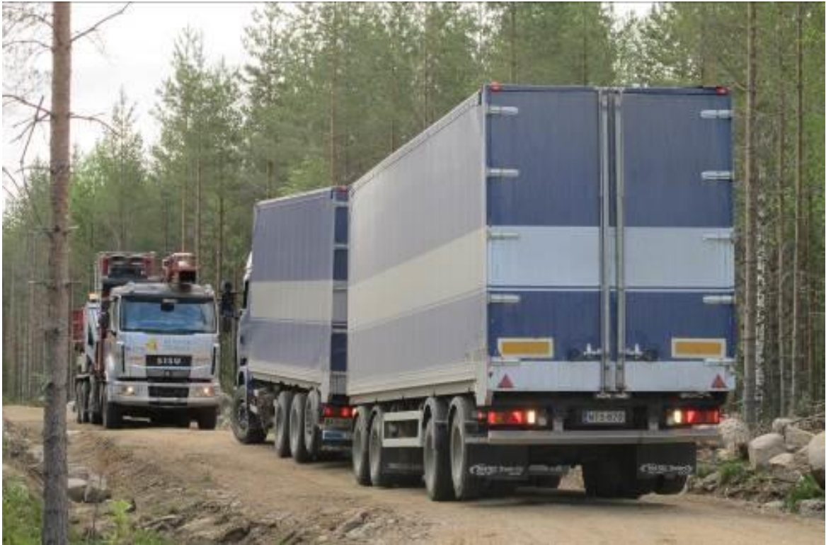
Kuva 3. Energiapuun haketus- ja kuljetuskalustolla on omat vaatimuksensa varasto- ja kääntymispaikoille.
