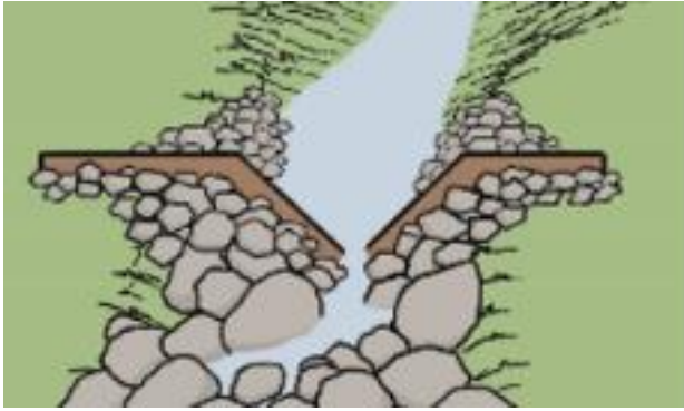
Kuva 13. V-padolla tarkoitetaan patoa, jossa on v-aukkoinen levy esimerkiksi vanerista. Vaneri kaive- taan maan sisälle sekä pysty- että sivusuunnassa, jotta pato kestää myös tulvavirtaamat. Levy tue- taan kivillä ja se voidaan halutessa peittää näkyvistä. Rakenne soveltuu pienehköihin kohteisiin.
