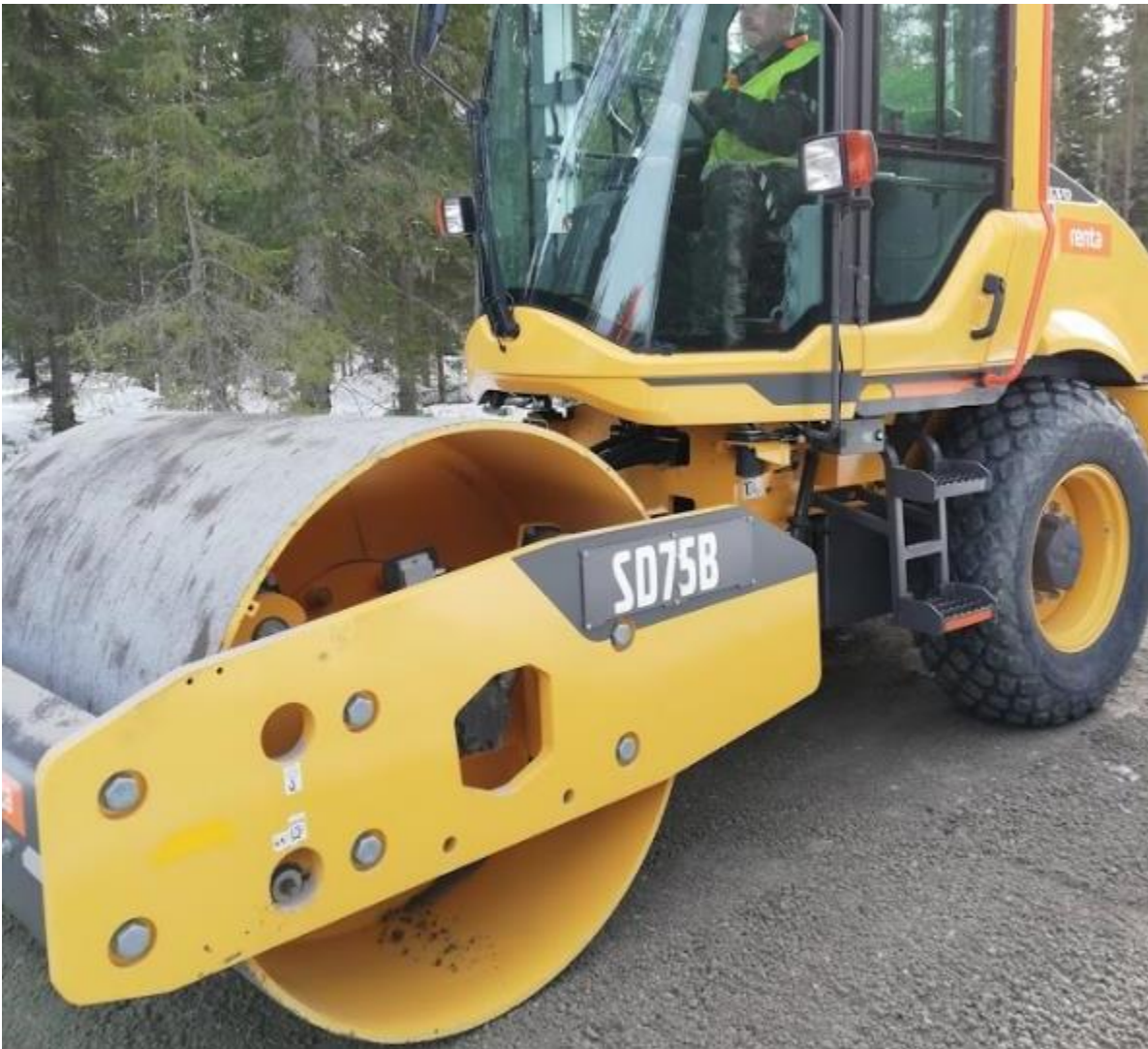
Kuva 16 Jyräys kannattaa aloittaa heti halutun kerrospaksuuden valmistuttua. (Kuva Jenni Nurmi)
