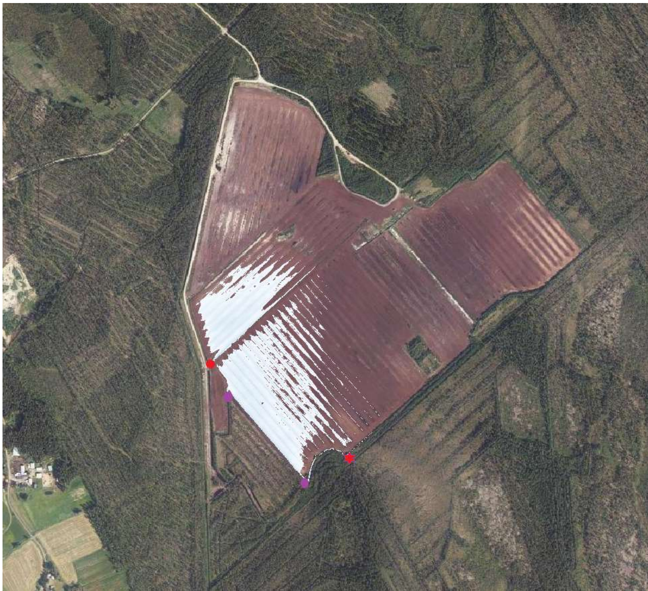
Kuva 4 Alueelle toteutettavissa oleva kosteikko. Selitteet: vaalea alue = kosteikon vesipinta, punainen piste = kosteikon padon sijainti, violetit pisteet = tukittavat paikat, punainen tähti = ulkopuolisten vesien johtaminen alueelle (kuva: MML)
