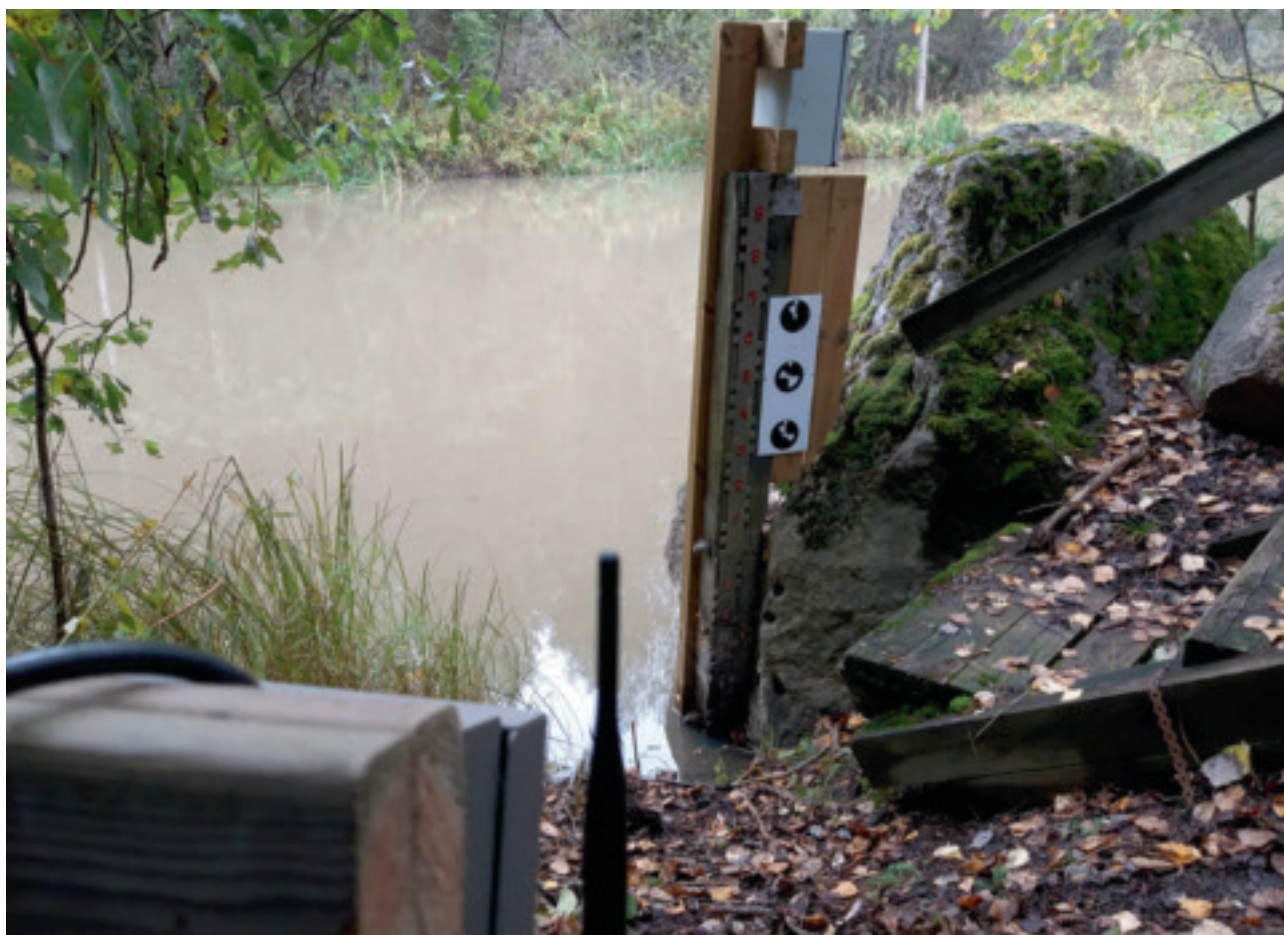
Kuva 2. Maankosteuden ja –lämpötilan mittausjärjestelyt Muuramessa lumen vesiarvon gammasäteilymittausaseman yhteydessä. Pylvään yläpäässä näkyvät IoT-mittalaitteet ovat Sigfox-verkossa toimiva Connected TempGuard 3-kanavainen lämpömittari ja LoRaWAN-verkossa toimiva Decentlab DL-5TM maankosteuden mittalaite.
