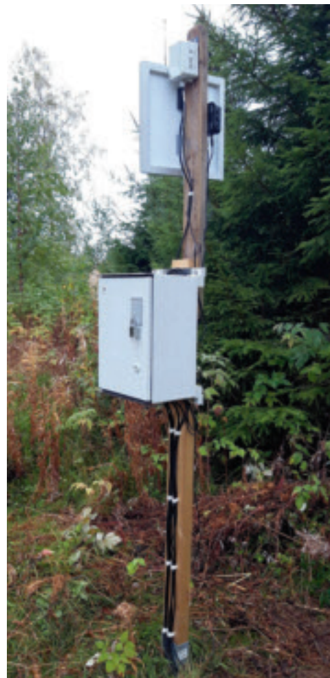
Kuva 1. Vedenkorkeuden mittaus Decentlab DL-PR26 LoRaWAN-mittalaitteella havaintoasemalla 1601100 Koskenkylänjoki, Niinikoski. Kuvassa nähtävillä myös asteikon etäluentaan ja automaattiseen kuvantulkintaan liittyvä kuvausjärjestely.
