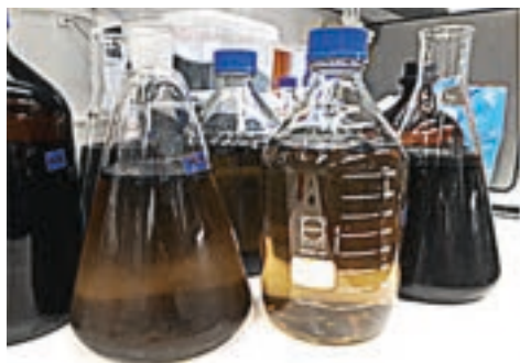
Kuva 2. Biohiilen kykyä adsorboida typpeä mitattiin laboratoriossa tehtävällä ravistelukokeella sekä kolonnikokeella, jossa valumavettä kierrätettiin biohiilellä täytettyjen kolonnien läpi.
