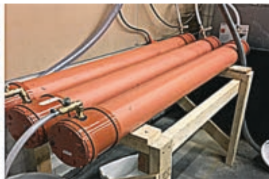
Kuva 2. Biohiilen kykyä adsorboida typpeä mitattiin laboratoriossa tehtävällä ravistelukokeella sekä kolonnikokeella, jossa valumavettä kierrätettiin biohiilellä täytettyjen kolonnien läpi.
