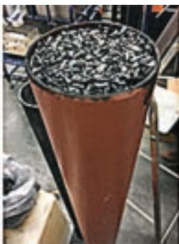
Kuva 2. Biohiilen kykyä adsorboida typpeä mitattiin laboratoriossa tehtävällä ravistelukokeella sekä kolonnikokeella, jossa valumavettä kierrätettiin biohiilellä täytettyjen kolonnien läpi.
