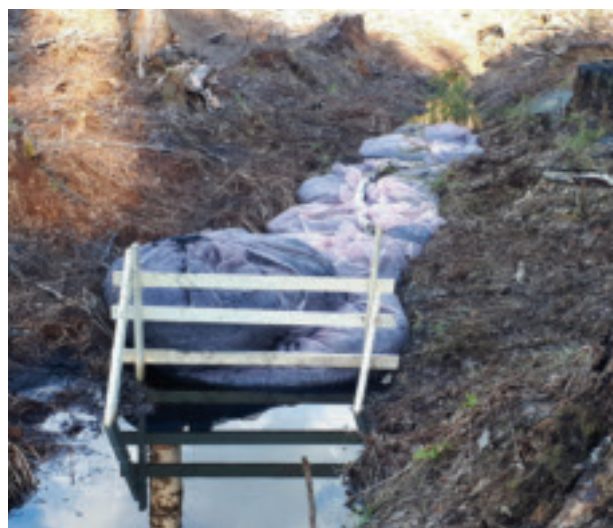
Kuva 3. Kenttäkoe, jossa ojiin on asennettu biohiilellä täytettyjä verkkopusseja.
