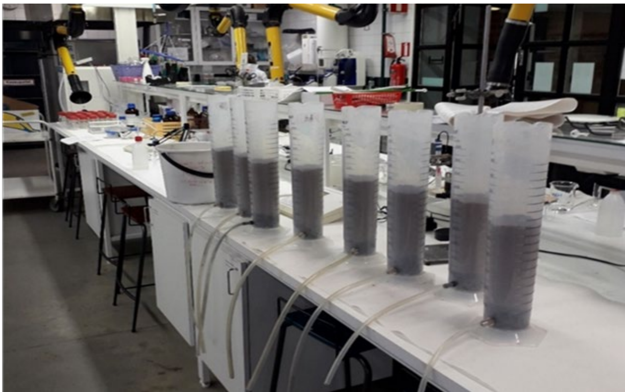
Kuva 5. Tuhkatiekolonnit, joihin on tehty maapohja (kuva Henna-Riikka Haikonen).
