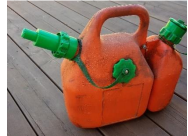
Kombikannusta voi irrottaa teräöljysäiliön, jota ei raivaussahan käytössä tarvita.
