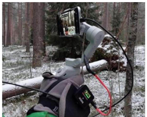
Kuva 2. Livelähetystä kuvataan älypuhelimella gimbaalin ja kämmentelällä olevan mikrofonivastaanottimen kanssa. Puhelin on yhteydessä johdoilla mikrofoniin ja varavirtalähteeseen. Langattomat mikrofonit ovat puhujilla kaulukseen kiinnitettynä.
