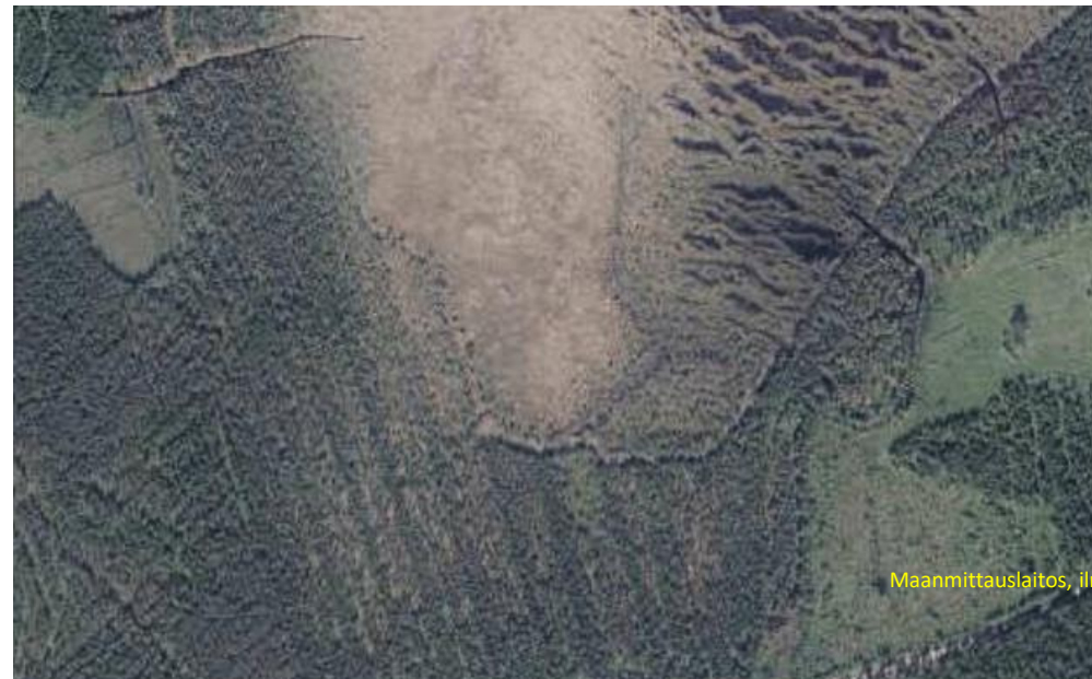
Pyhäjärvi, Vihtanevan etelänurkka Ilmakuva v. 2021 (n. vuosi toimenpiteiden jälkeen) Havaitaan, että vesi palannut kuivuneisiin rimpiin
