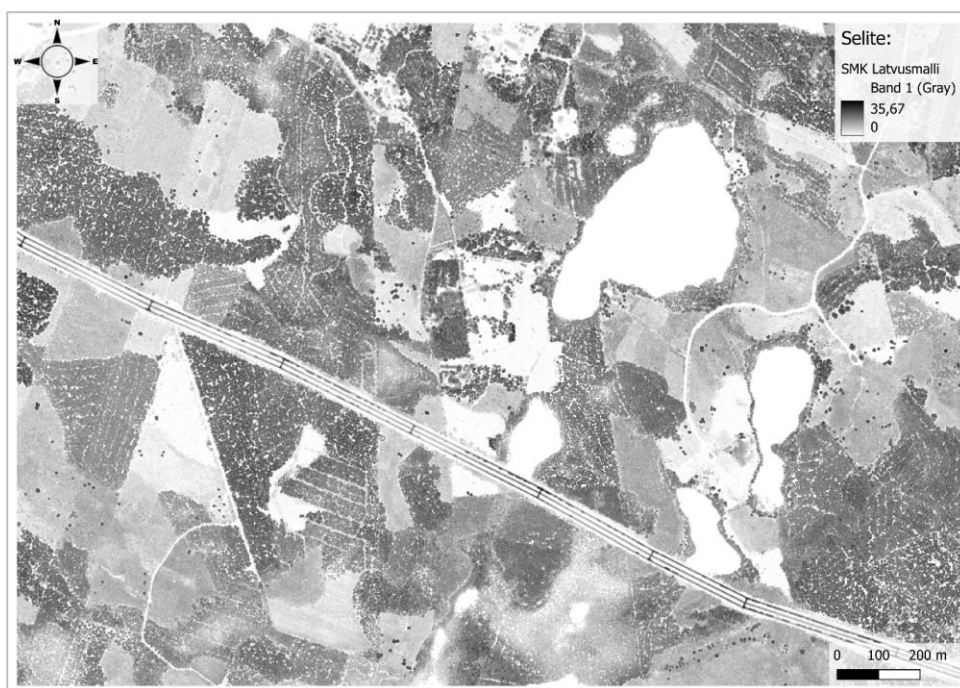
Kuva 2. Esimerkki Metsäkeskuksen tuottamasta latvusmallista.
