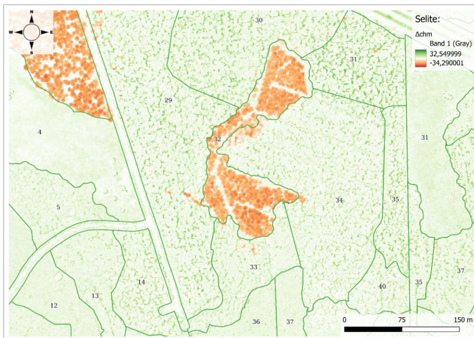
Kuva 4. Kahden ajankohdan latvusmallin erotuksesta tuotettu pituuden muutokartta.
