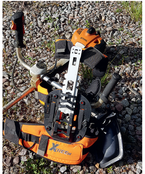
Kuva 22. Sahaajan vartalon koon mukaan pituussäädettävä selkäosa parantaa raivaussahavaljaiden käyttömukavuutta. Pituussäädettäviä valjaita suositellaan erityisesti silloin, kun raivaussahalla työskennellään pidempiä jaksoja.
