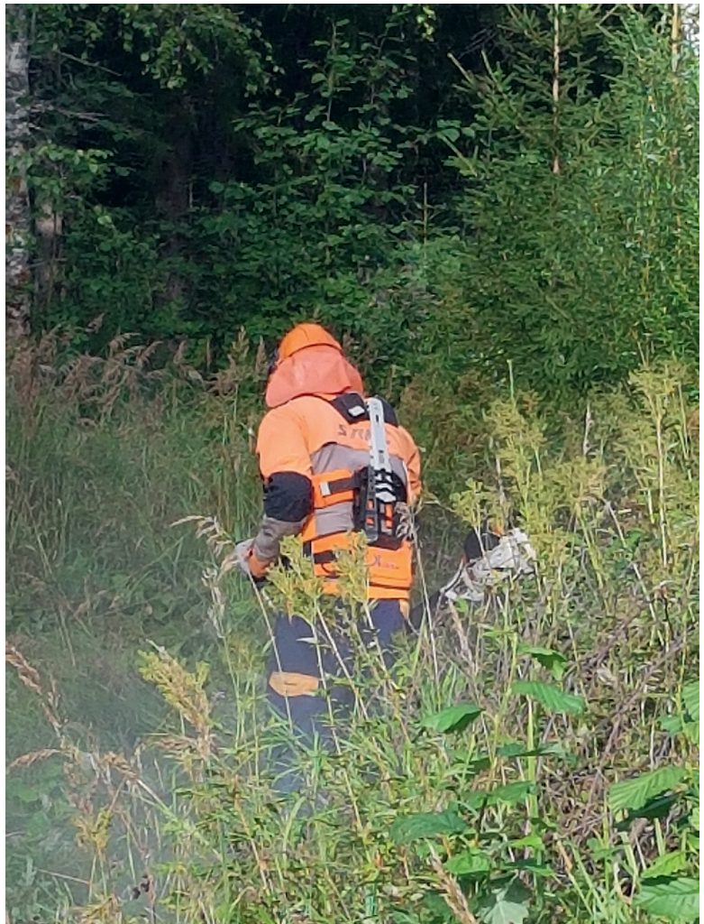
Kuva 12. Vesakkoterällä varustettu raivaussaha sopii metsänuudistamisalojen heinäntorjuntaan, varsinkin kohteilla, joissa haittaava kasvusto on vahvaa, esimerkiksi vadelmaa.
