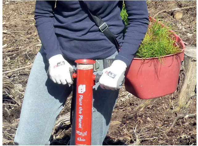
Kuvat 15 ja 16. Taimivakan voi sijoittaa vartalon oikealle tai vasemmalle puolelle istuttajalle sopivan työtekniikan mukaan. Istutustyössä on käytettävä käsineitä ja peittävää vaatetusta.
