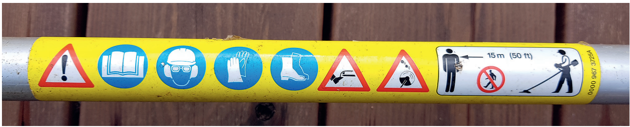
Kuva 28. Raivaussahan runkoputkessa on yleensä kerrottu kuvilla tärkeimmät turvallisuusohjeet. Kahden henkilön työskennellessä raivaussahoilla samalla työmaalla, on noudatettava 15 metrin turvaetäisyyttä.
