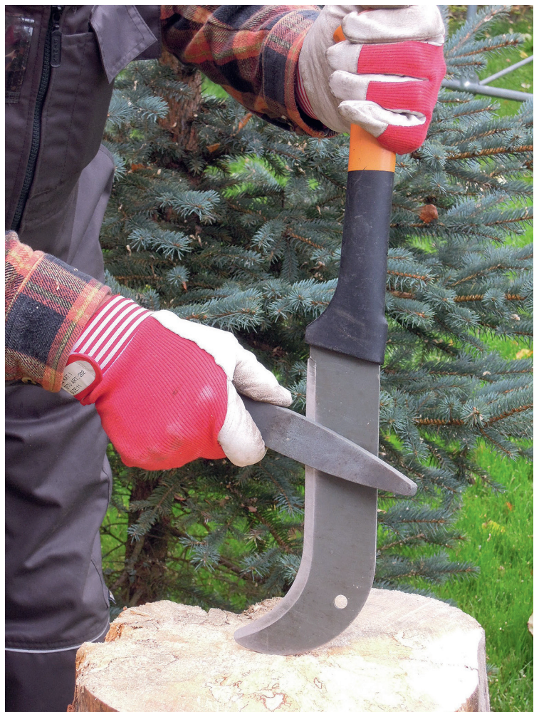
Kuva 29. Yhden käden vesuri sopii pienikokoisen vesakon perkaamiseen. Vesurin terä kannattaa kunnostaa säännöllisesti.
