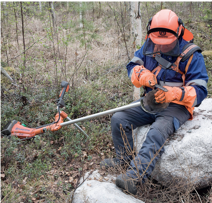
Kuva 23. Raivaussahan terää teroitettaessa on käytettävä suojakäsineitä.
