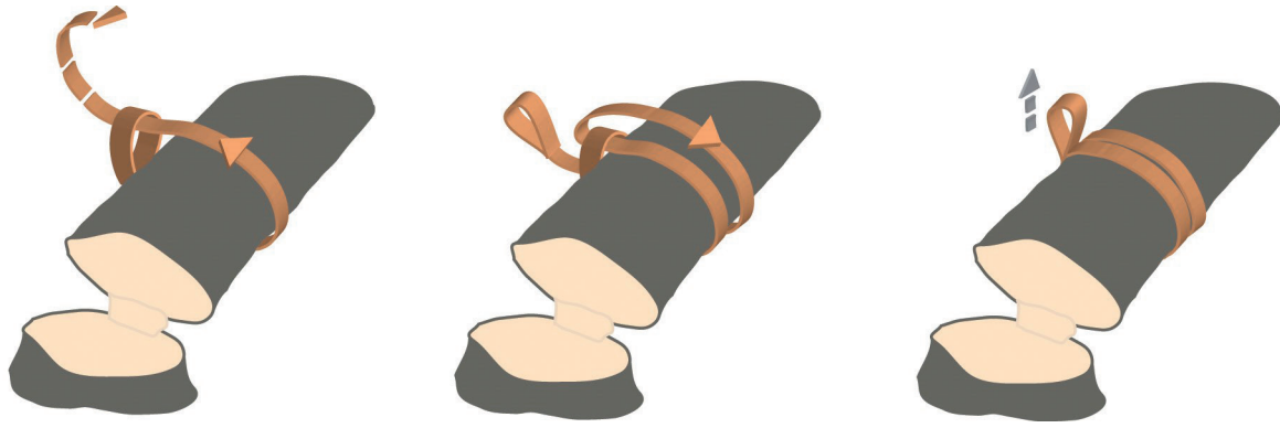
Kuva 46. Konkeloliinan kiertäminen rungon ympäri. Puukanki pujotetaan liinan silmukkaan.
